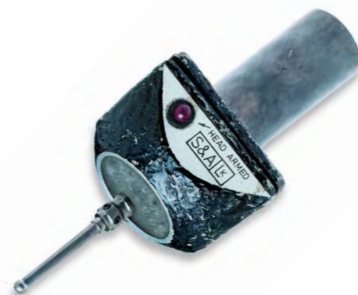
Первый триггерный контактный датчик компании Renishaw
